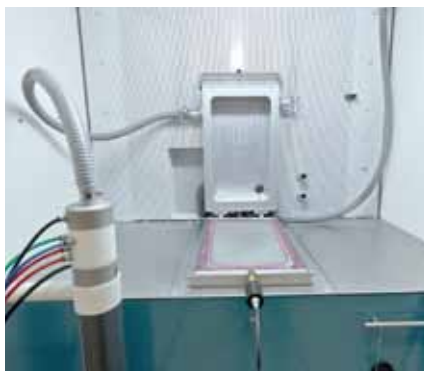
Nel doppio locale polveri realizzato, il colore successivo viene preparato già durante la verniciatura stessa.
