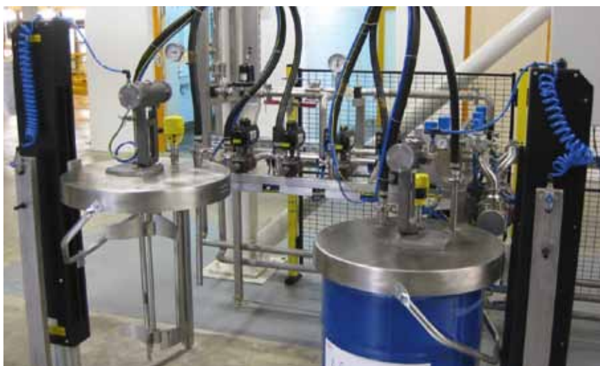
Sala di verniciatura Mini Mix per l'applicazione di colori specifici sulle linee di produzione.
