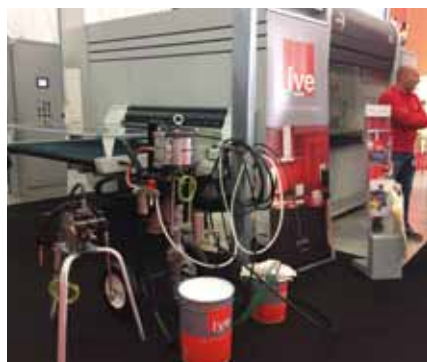
Macchina "Mito" di Cefla attrezzata con la pompa MX alta pressione di Binks e pistole automatiche AG-363 da Binks.
