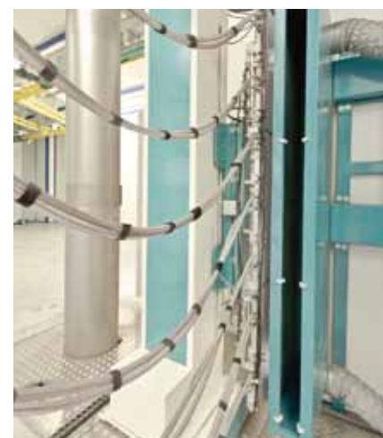
Per il cambio di colore le pistole automatiche entrano nel "Sandwich" dove viene eliminata la polvere residua sia all'esterno sia all'interno.
