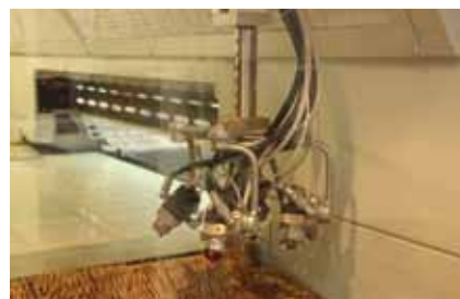
Pistole automatiche AG-363 alta pressione Binks attrezzano la macchina di Cefla "Mito".
