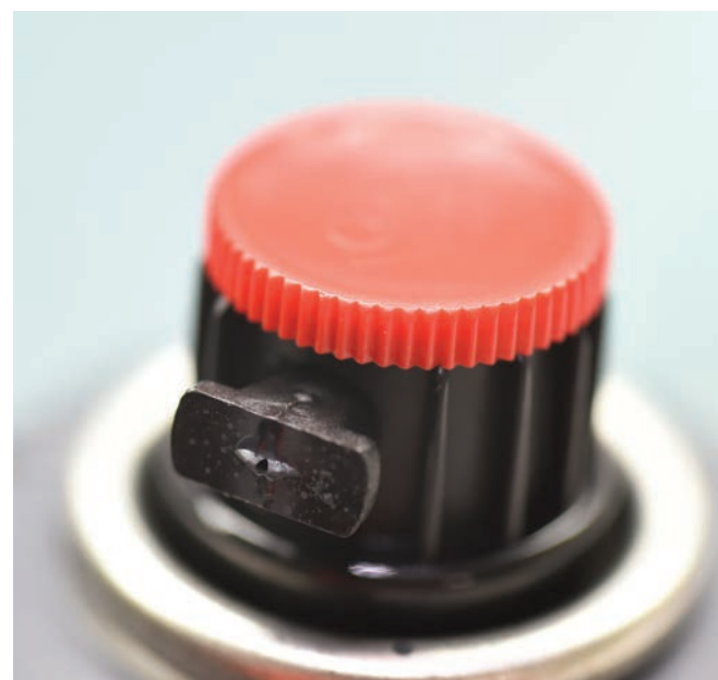
La testina di spruzzo con possibilità di variare l'erogazione e il ventaglio di spruzzo da 50 a 100 mm di copertura
